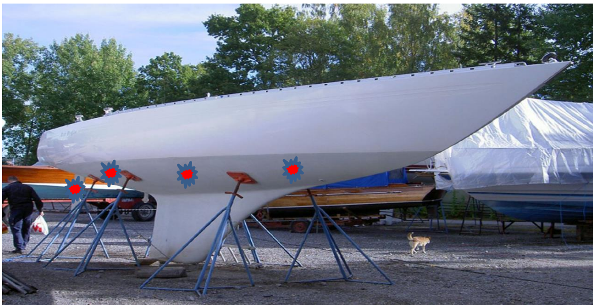
Figur 1. Mätpunkter på båtar mätta av Happy Boat AB. Mätningar utfördes 10-30 cm nedanför vattenlinjen på både styrbord och babord sida enligt bilden (styrbord bak, styrbord mitt, styrbord för, babord för, babord mitt och babord bak plus ömse sidor av roderet). På motorbåtar utan roder mättes på akterspegeln eller drevstocken.
